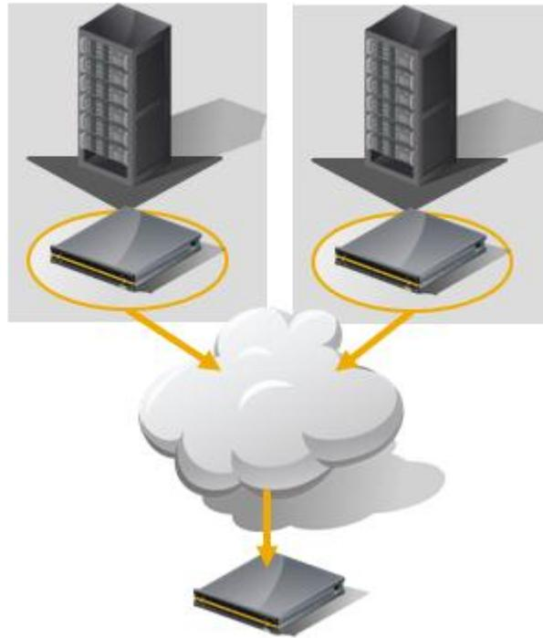
Nexsan 的远程复制如图所示，可以是“一对一”的复制方式，也可以是“一对多”或“多对一”的复制。即一个存储的数据复制到多个远程存储或多个存储的数据复制到同一远程存储；而且复制可以是双向的。“多对一”的复制在具有多个分支机构的企业尤为重要，通过 IP 网络的延伸，可以方便实现数据跨地区集中。
